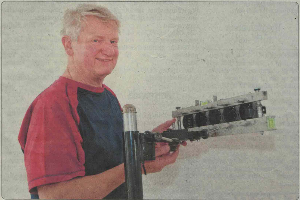
Horst Wirschnitzer aus Eisfeld, Handwerksbetrieb für Elektroinstallation und Hausgeräte, präsentiert die schutzrechtlich gesicherte Vorrichtung zur Positionierung von Unterputzgerätedosen „DOSENFIX“. Foto: J. Dahlems
